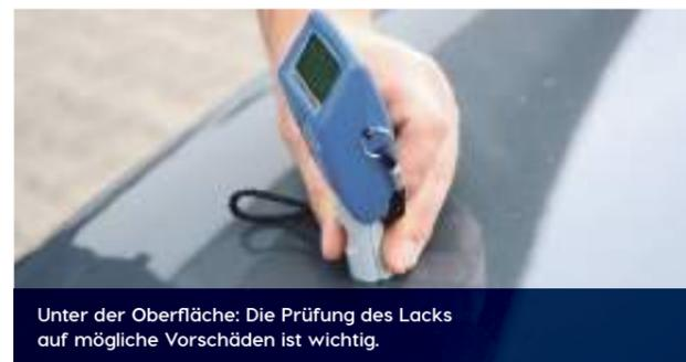
Unter der Oberfläche: Die Prüfung des Lacks auf mögliche Vorschäden ist wichtig.
