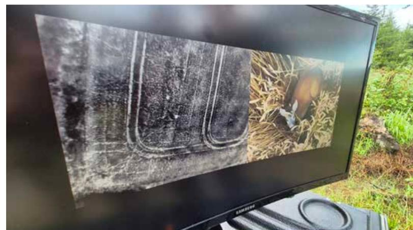
**Live-Aufnahme der Drohnenkamera: Links das Bild der Wärmebildkamera mit deutlicher Erkennbarkeit eines warmen Tierkörpers, rechts die Realaufnahme**
